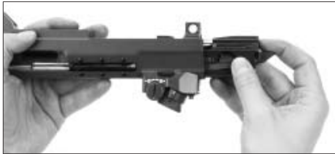
illu. 52) Insert bolt assembly
