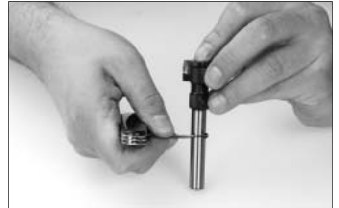
illu. 47) Remove firing pin
