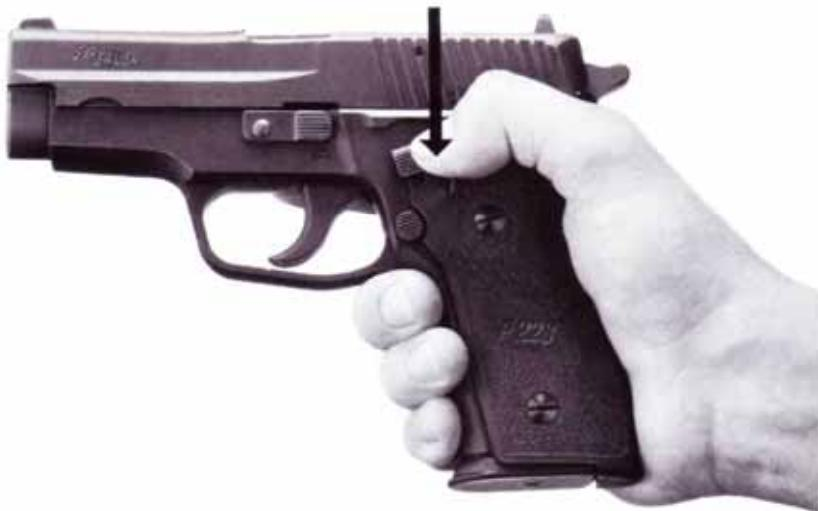
Dadurch wird der Schlaghebel gespannt und eine Patrone in das Rohr eingeführt.
