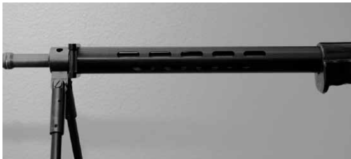
Bild 16: Mantelrohr zu Stgw 57
