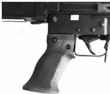
Figura 13: Impugnatura a pistola Tactical per F ass 57
