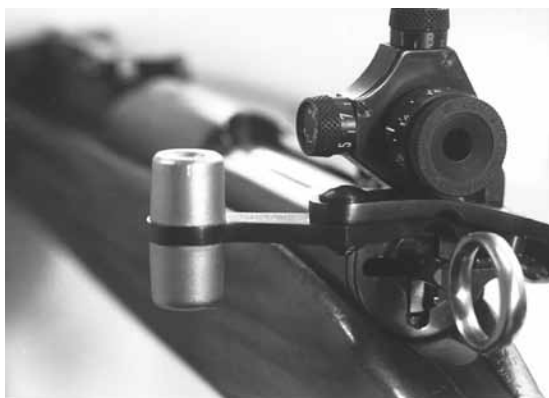
Bild 18: Linksriegel zu Karabiner 31
