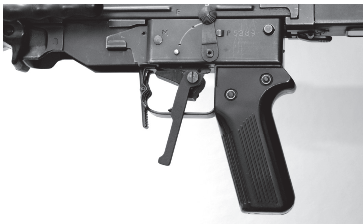
Figure 19: Détente d'hiver pour tireurs gauchers pour F ass 57
